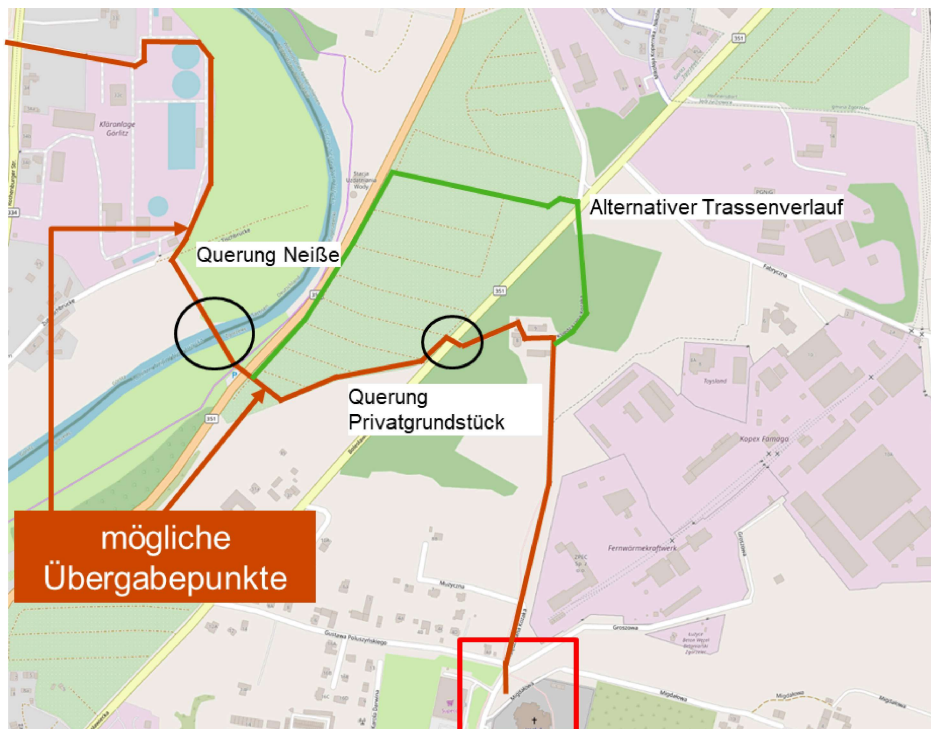
Abbildung 21: Trassenverlauf zur Anbindung des Wärmenetzes an die grenzüberschreitende Leitung
