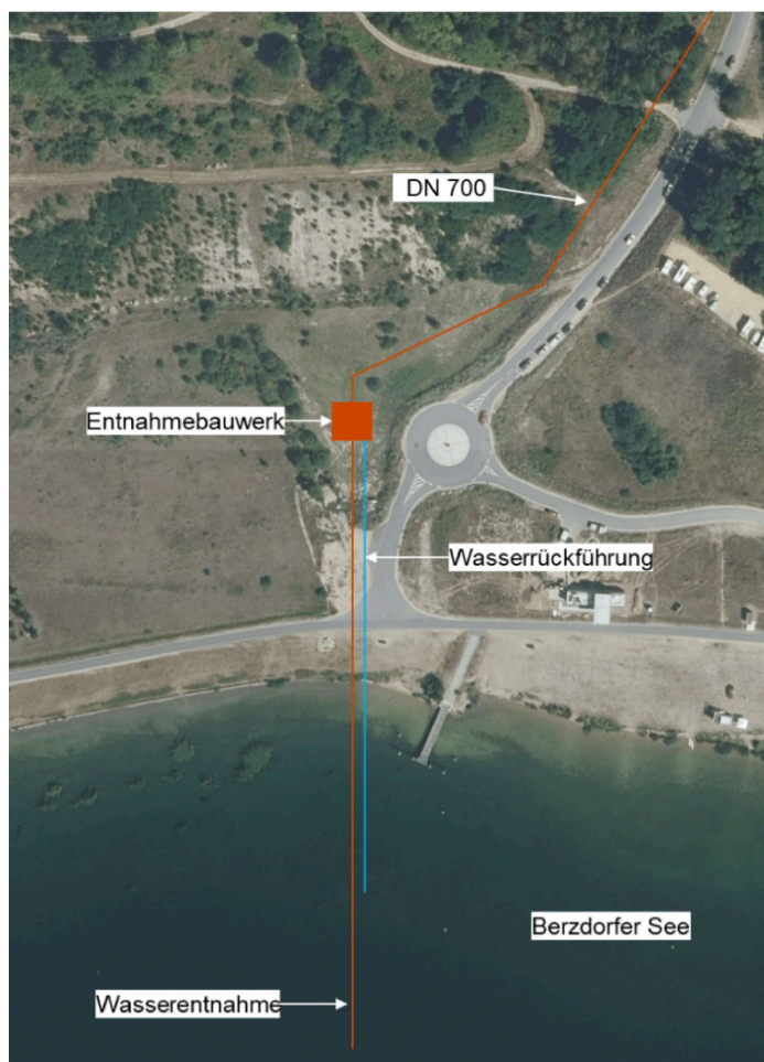
Abbildung 16: Geplanter Aufbau der Wasserentnahme für die Seewasser-Wärmepumpe.
