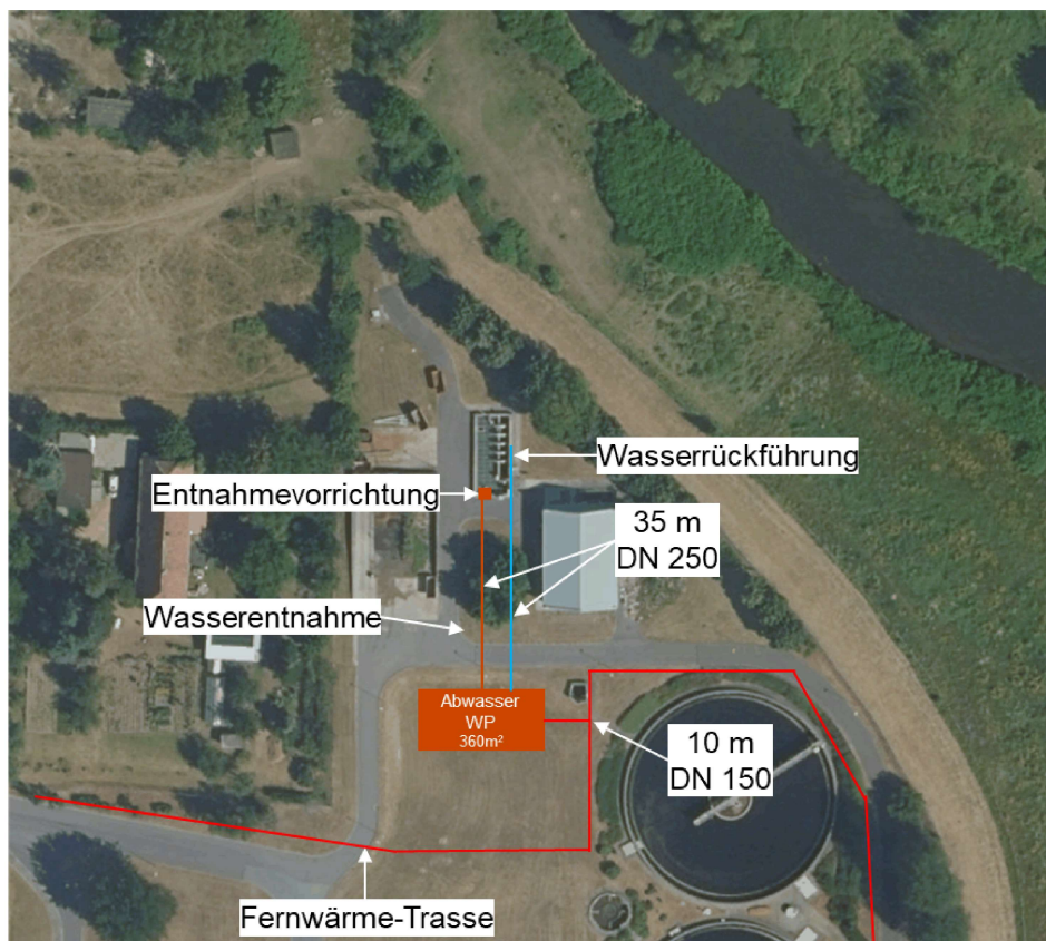
Abbildung 19: Geplanter Aufbau der Abwasser-Wärmepumpe
