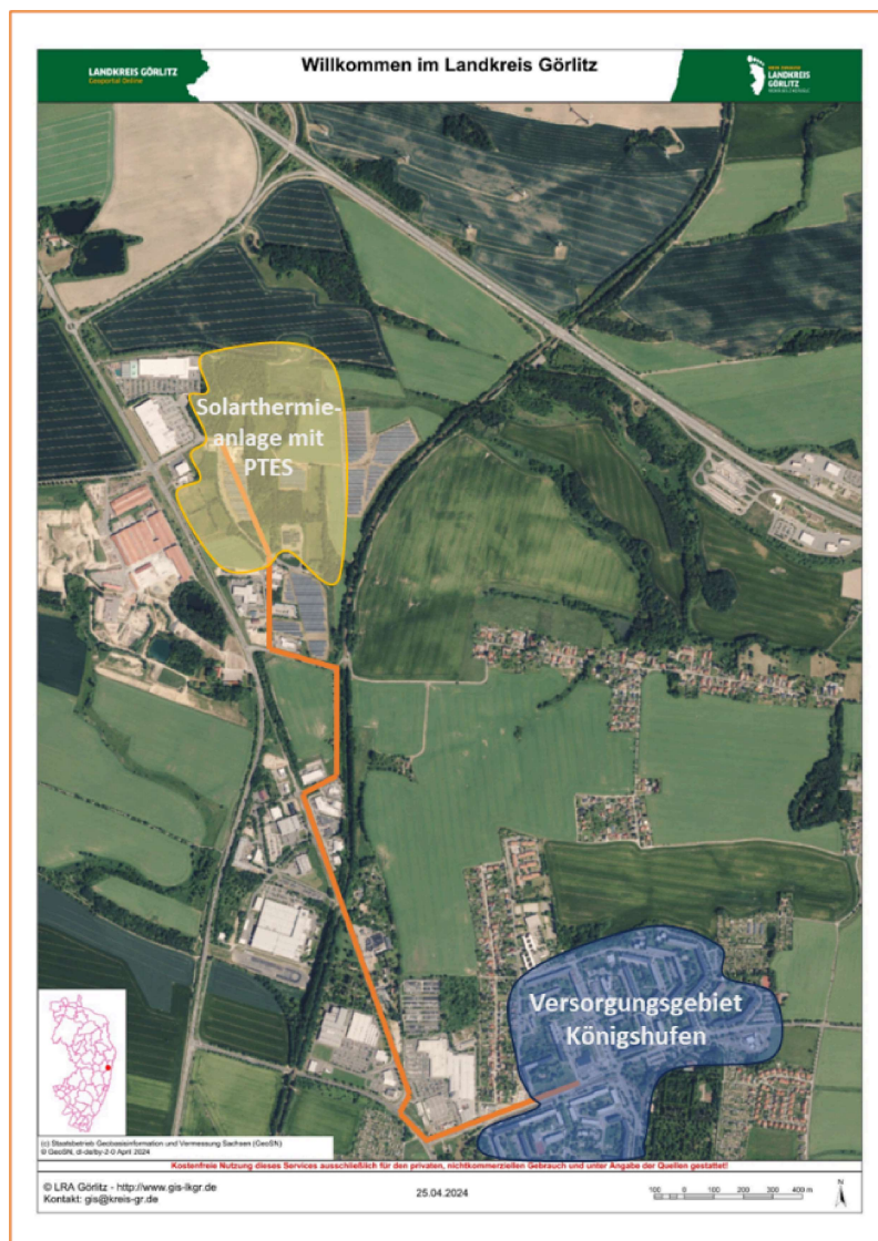
Abbildung 31: Geplante Anbindung der Solarthermieanlage an das Wärmenetz.
