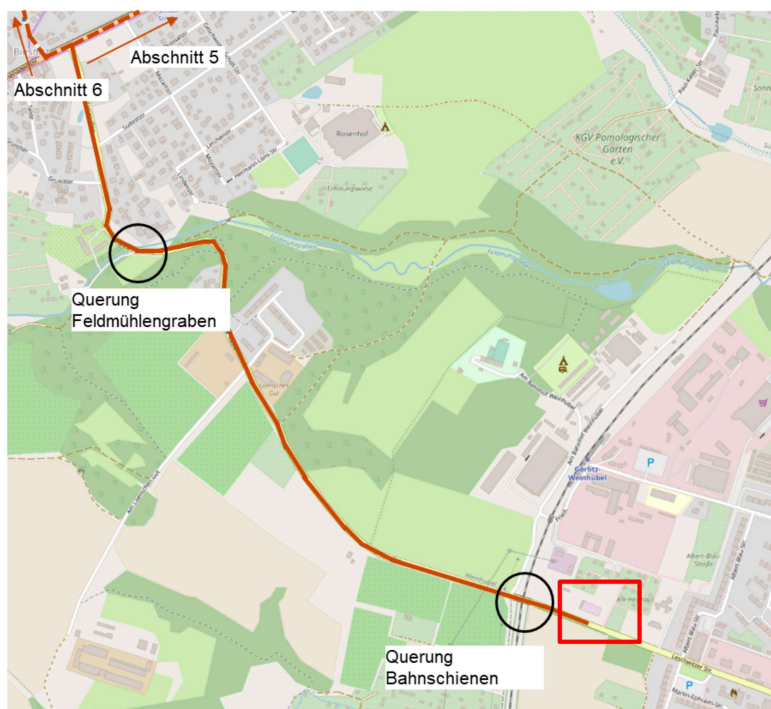
Abbildung 30: Geplanter Trassenverlauf und kritische Stellen Anschluss Weinhübel
